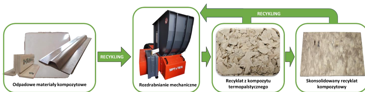
Rysunek 1 Schematyczne przedstawienie procesu mechanicznego recyklingu kompozytów termoplastycznych.
